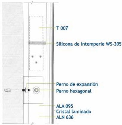
CORTE VERTICAL - ANCLAJE TÍPICO DET 6
